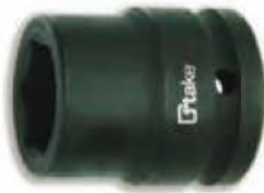
5035 1/2 ME Chiave a bussola macchina con bocca esagonale, attacco 1/2", acciaio speciale al cromo molibdeno, esecuzione fosfatata.
