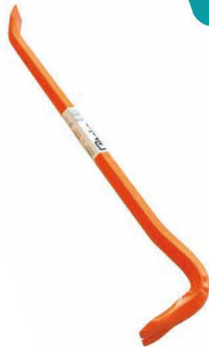
5085 Leverino per carpentiere a sezione esagonale, con leva e levachiodi in acciaio temperato e apposita curvatura nelle zone attive. Verniciatura a polvere epossidica.
