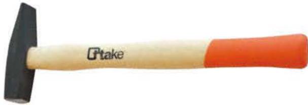
5082 Martello per meccanici , modello tedesco. Testa piana quadra in acciaio temperato e manico in legno. DIN 1041.
