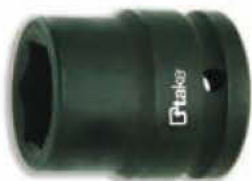
5035 1 ME Chiave a bussola macchina con bocca esagonale, attacco 1" , acciaio speciale al cromo molibdeno, esecuzione fosfatata.
