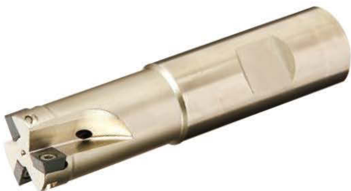
Fresa per spallamenti retti 89,50° TA9406 , con fori di refrigerazione, 4 taglienti utili, inserto altezza 6mm.
