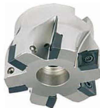
Fresa per spallamenti retti 89,50° TA9409 , con fori di refrigerazione, 4 taglienti utili, inserto altezza 9mm.
